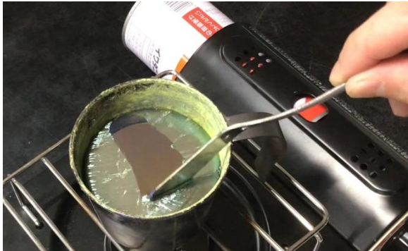
図3 液面の酸化皮膜をヘラで取り除く様子
