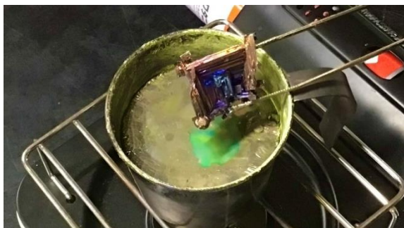
図4 液面付近でゆっくりと酸化させる様子
